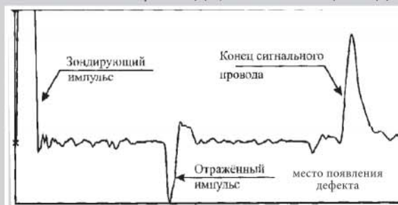
Рефлектограмма сигнального провода, имеющего дефект типа "намокание изоляции"
